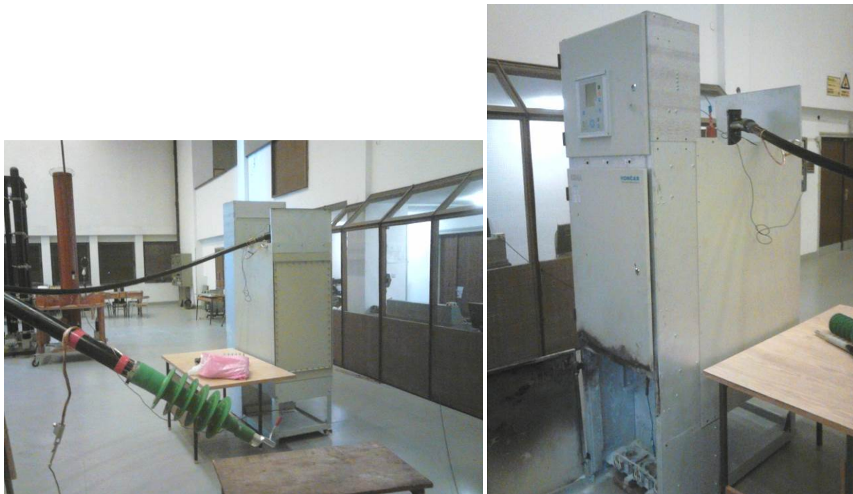
Slika 10. i 11. Ispitivanje sklopnog modula u laboratoriju visokog napona
